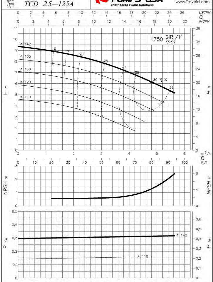
Dati riferiti ad acqua a temperatura ambiente. Per condizioni di collaudo e tolleranze consultare la tabella specifica. These data are relevant to water at ambient temperature. For testing conditions and tolerances pls consult the relevant table.
