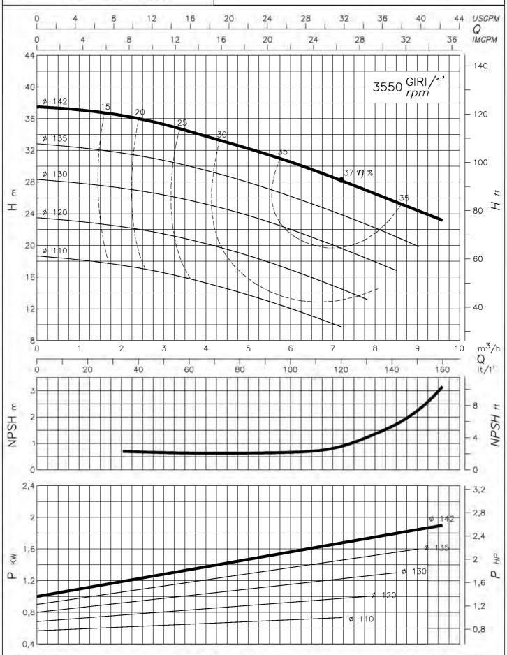
Dati riferiti ad acqua a temperatura ambiente. Per condizioni di collaudo e tolleranze consultare la tabella specifica. These data are relevant to water at ambient temperature. For testing conditions and tolerances pls consult the relevant table.
